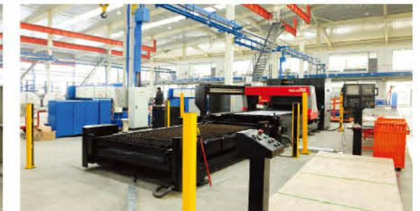
Японское оборудование лазерной резки AMADA FO-3015
