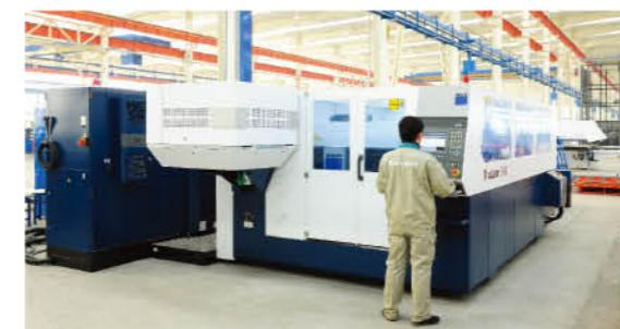
Немецкое оборудование лазерной резки Trumatic L 3030
