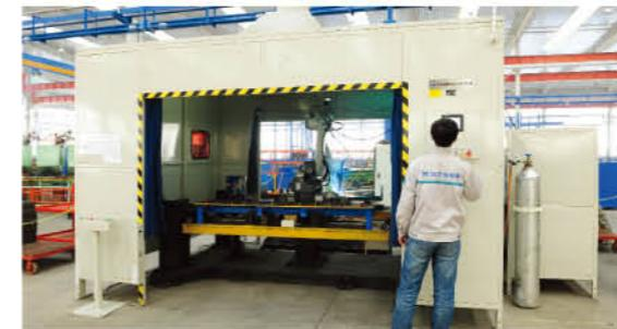
Японское оборудование автоматизированной сварки
