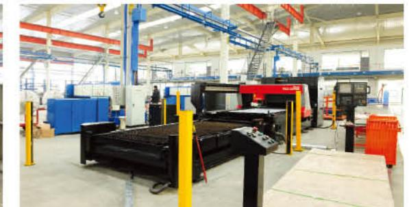
Японское оборудование лазерной резки AMADA FO-3015
