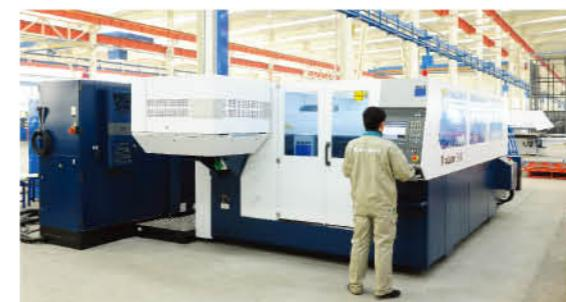
Немецкое оборудование лазерной резки Trumatic L 3030
