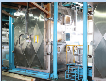
Вакуумная пропитка обмоток
