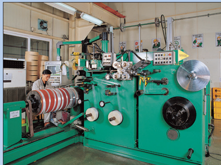
Изготовление обмоток высокого напряжения
