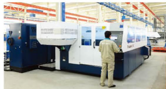
Немецкое оборудование лазерной резки Trumatic L 3030
