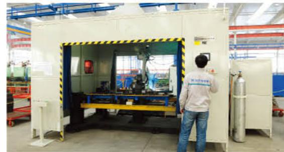
Японское оборудование автоматизированной сварки
