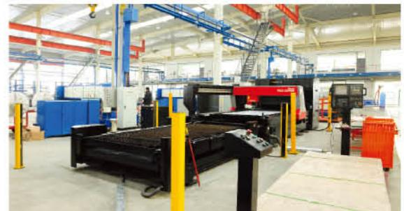
Японское оборудование лазерной резки AMADA FO-3015
